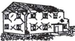
**Degré 4: Dégâts très importants (dégâts structuraux importants, dégâts non structuraux très importants)** Défaillance sérieuse des murs; défaillance structurale partielle des toits et des planchers.
