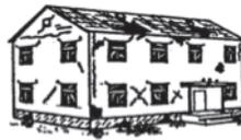
**Degré 3: Dégâts sensibles à importants (dégâts structuraux modérés, dégâts non structuraux importants)** Fissures importantes dans la plupart des murs. Fractures des cheminées à la jonction avec le toit; défaillance d'éléments non structuraux séparés (cloisons, murs pignons).
